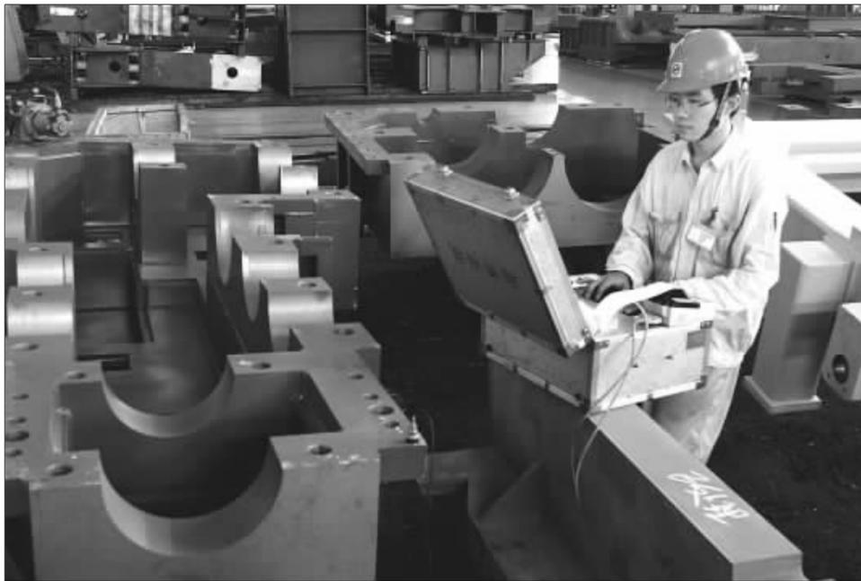
今年以来,工程技术公司苏冶厂通过增加振动仪对钢结构件的检测,降低了热处理的电耗,迄今已节电77万元。图为员工正在现场进行产品检测。
