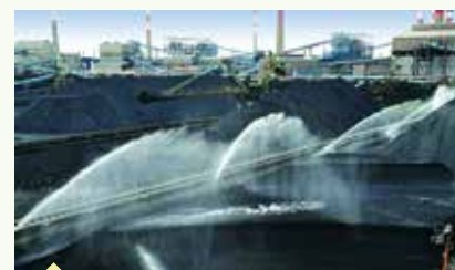
宝钢股份煤场抑尘洒水作业
